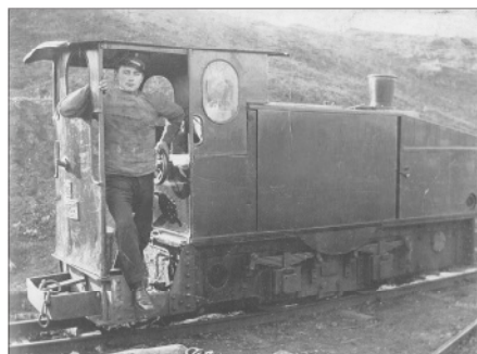
August Kauss aus Stockhausen auf einer Benzollok Deutz Typ 12 wie sie hier ab 1909 im Einsatz war. Die Lok mit der Leistung von 16 PS erreichte eine Höchstgeschwindigkeit von 10 kmh und hatte eine Spurweite von 50 cm.
