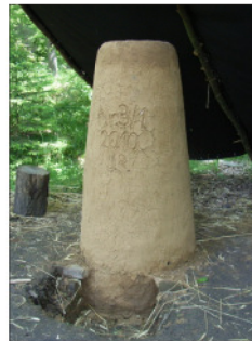
Nachbau eines Rennofens zur Eisenschmelze im Hessenpark
