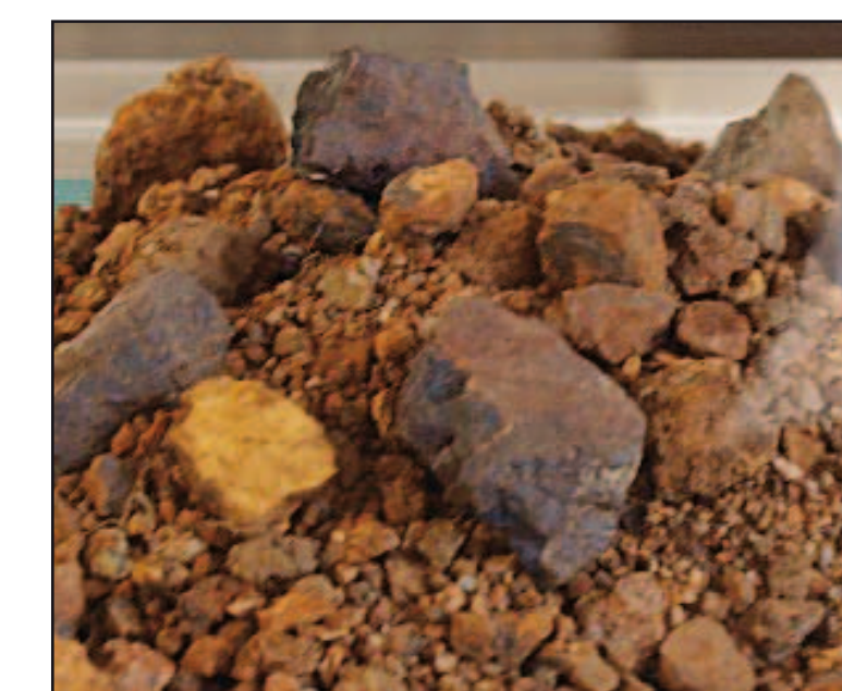
Wascherzstück mit gut sichtbaren Eisenkrusten, Basaltzersatz mit eingebettetem Stückerz (Fotos: Karl Heinz Hartmann)
