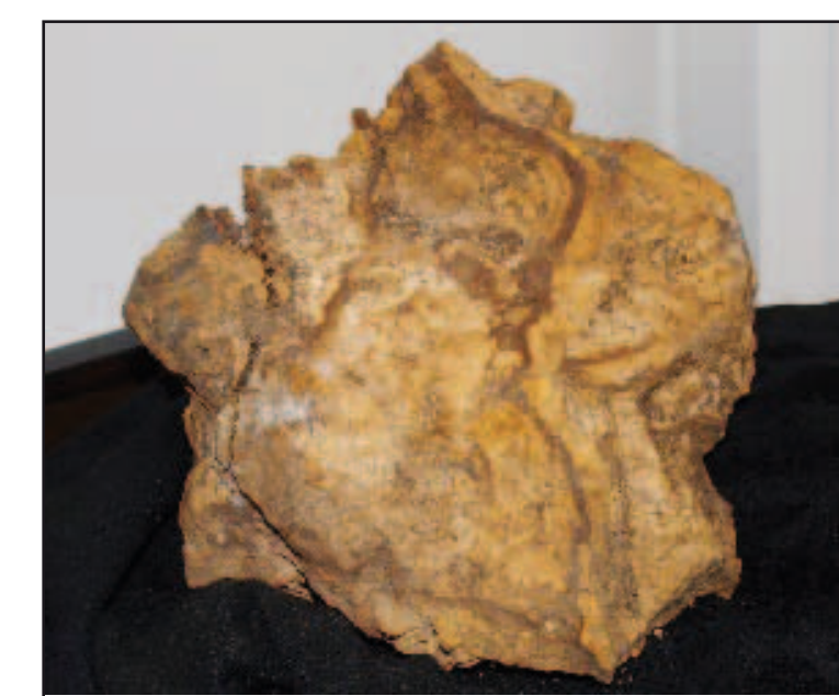
Wascherzstück mit gut sichtbaren Eisenkrusten, Basaltzersatz mit eingebettetem Stückerz (Fotos: Karl Heinz Hartmann)
