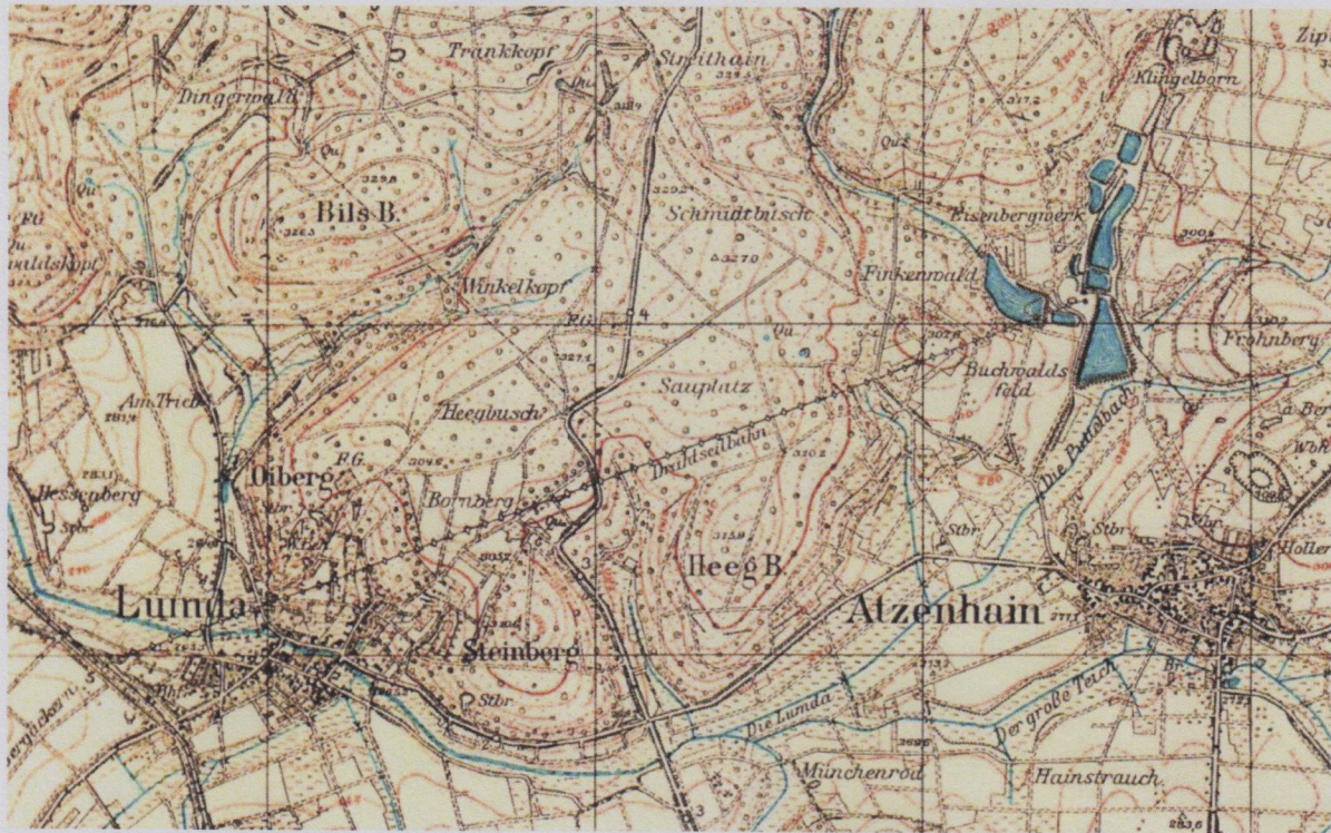
Karte mit Seilbahn von der Grube Atzenhain (rechts oben mit Waschteichen) zur Entladestation am Nebengleis des Bahnhofs Lumda (li. unten), Karte nach 1912.
